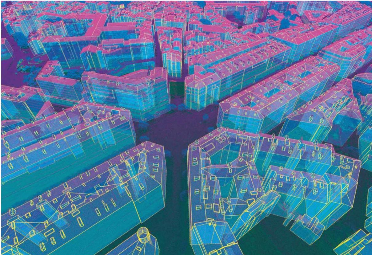
Reconstruction automatique 3D de bâtiments depuis un nuage de points LiDAR HD, Marseille, 2020.
